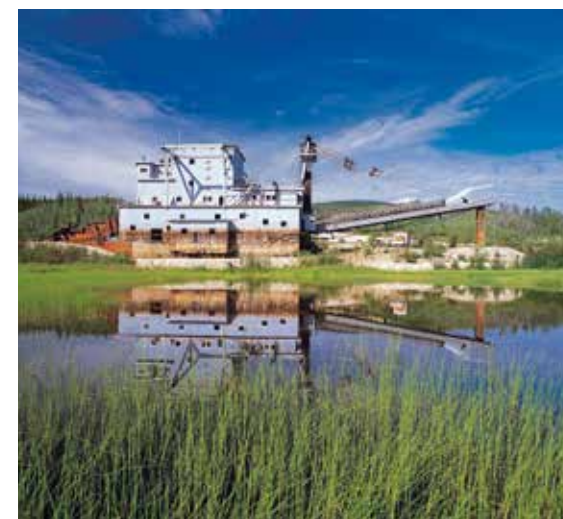
Dredge #4: enorme zuigmachines werden ingezet op zoek naar goud in de Bonanza Creek
